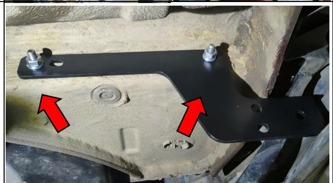
**ШАГ 3.** Установить центральную перекладину (поз 1), соединив ее с боковыми кронштейнами (поз. 2) с помощью болтов M12x1,25x35 (поз. 8) и шайб 12, шайб 12 пружинных (поз. 9,10). Затяните соединения всех элементов.
