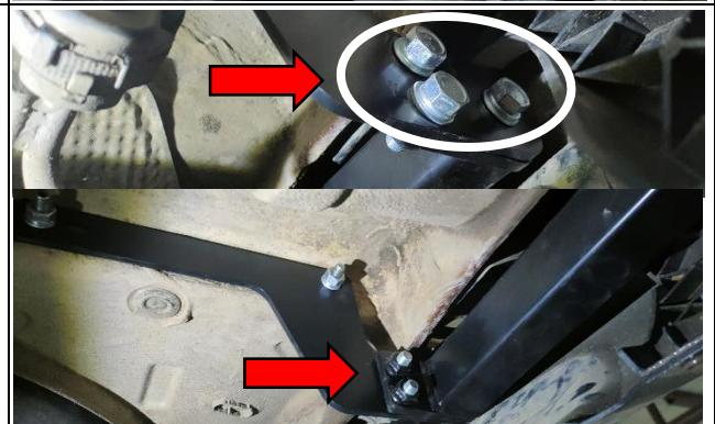
**ШАГ 4.** Установить съемный шар (поз. 15) закрепив его пальцем (поз.11) и шплинтом (поз. 16). Закрепить съемный шар болтами M12 (поз. 8) через шайбы 12 и пружинные шайбы 12 (поз. 9,10). Установить кронштейн розетки (поз 14) и закрепить ее гайкой M8 (поз. 12) через шайбу 8 пружинную (поз. 13). Подключить электрику: розетку, жгут проводов, блок согласования (если требуется).
